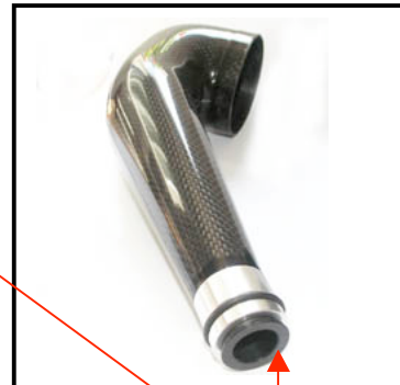
Fig N°5 Montée avec la bague de limitation d'entrée d'air
